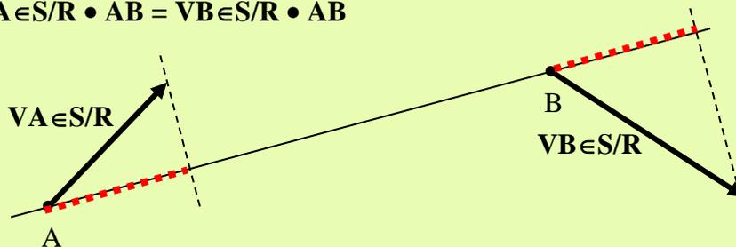
4. Torseur cinématique d'un solide en mouvement dans le repère  $R_0$
