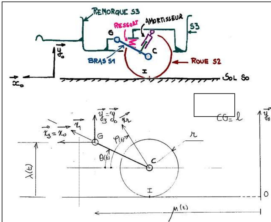
Le schéma ci-contre représente une remorque  $S_3$ . L'essieu arrière est articulé en  $G$ . Un bras  $(GC=l)$   $S_1$  est en liaison pivot  $(Gz)$  avec la remorque ; les roues  $S_2$  sont en liaison pivot  $(Cz)$  avec le bras.
