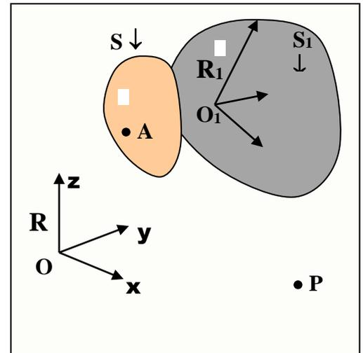
On démontre alors la relation de composition des vecteurs vitesse pour un point P qui se déplace dans R, pour un solide  $S_1$  auquel est attaché le repère  $R_1$  :
