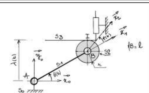
Le moteur fait tourner la roue dentée  $S_2$  qui roule sans glisser sur  $S_3$ .
