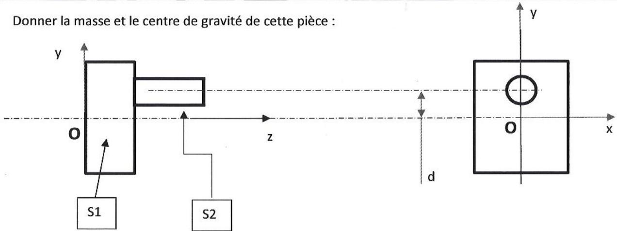
Parallélépipède S1 : hauteur (y) = 40mm ; largeur(x) = 30mm ; épaisseur(z) = 20mm
